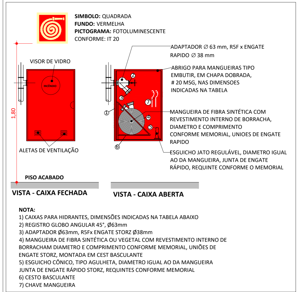
DETALHE DE INSTALAÇÃO DO HIDRANTE INTERNO (HI)
